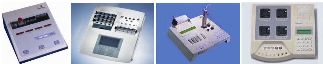
Рис.1 Различные виды полуавтоматических коагулометров.
